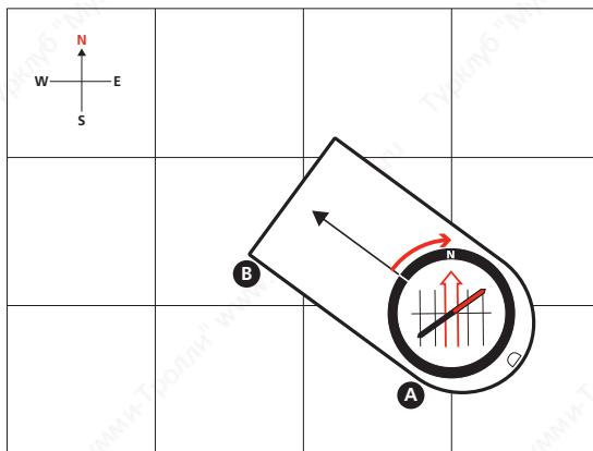
3. Держите компас параллельно земле на уровне пояса и поворачивайтесь до тех пор, пока стрелка компаса и ориентирующая стрелка не совпадут.
